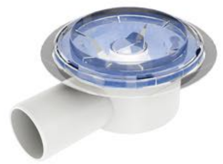
Waagrechtter Ablauf mit exzentrischen Kopf zur Feinpositionierung, Dichtmanschette, Schutzkappe
